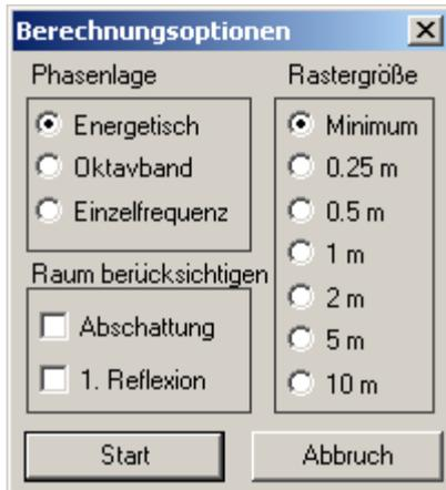
Wählen Sie "**Energetisch**" im Feld "**Phasenlage**" (hiermit wird die energetische Summe aller Quellen ohne Interferenzeffekte berechnet). Lassen Sie den Raum unberücksichtigt (keine Haken im Feld "**Raum berücksichtigen**").
