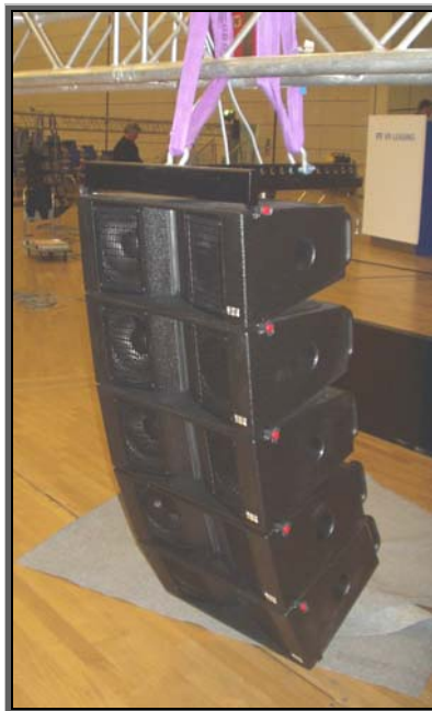
Abb. 2-1 Line-Array-System bei der Installation
